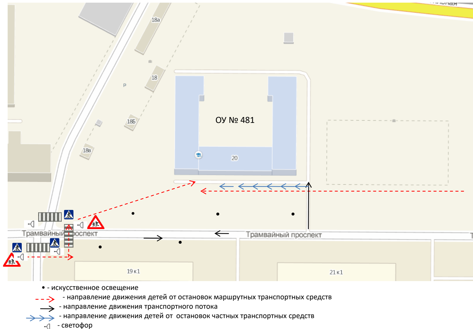
2 а. Схема организации дорожного движения в непосредственной близости от ОУ с размещением соответствующих технических средств, маршрутов движения детей и расположения парковочных мест (филиал)
